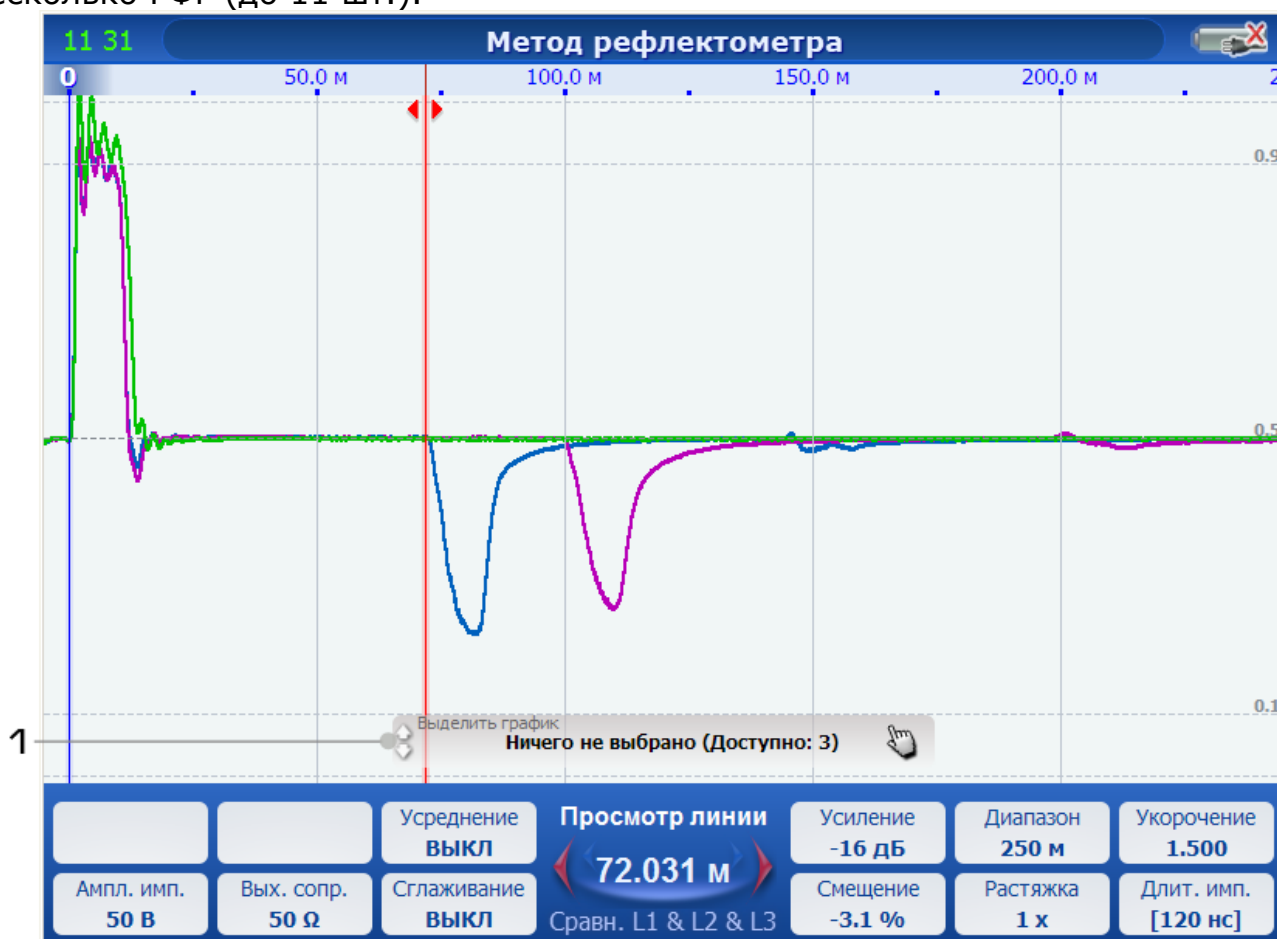
Рис. 51. Иллюстрация к режиму измерения с одновременным отображением нескольких РФГ (1 – компонент выделения РФГ).
